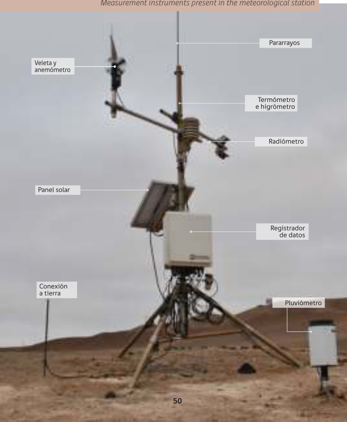
[21] Instrumentos de medición presentes en la estación meteorológica Measurement instruments present in the meteorological station
